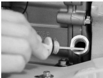
Fig. 5 – Verificarea nivelului de ulei la motor
